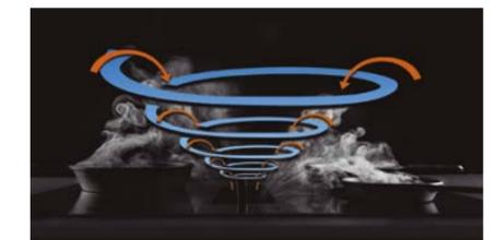
Grâce à sa conception, la zone d'aspiration du Flow5 produit un flux d'air à grande vitesse générant un effet d'attraction qui s'étend plus haut, attirant les fumées vers le centre et les conduisant à l'intérieur.
