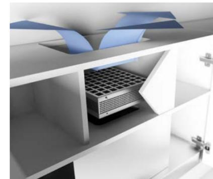
Il extrait l'air sur tout son périmètre, réduisant ainsi la friction et la pression. Pour assurer une bonne circulation de l'air à la sortie des filtres, il est recommandé de laisser un espace minimal de 30 mm entre le filtre et le conduit décoratif ou l'encastrement.
